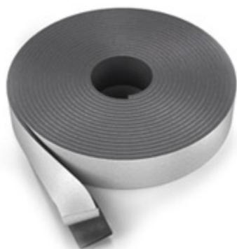
Лента самоклеящаяся Energoflex® Super SK из вспененного полиэтилена обладает низким коэффициентом теплопроводности ( $\lambda_0=0,035$  Вт/(м·°C) и предназначена для изоляции фитингов, арматуры и труднодоступных участков трубопроводов в системах отопления и водоснабжения, а также для уплотнения различных соединений.
